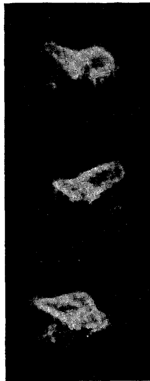
Fig. 3. Tre Afbrydningsgnister, hver indeholdende en Energi paa ca. 1.6 Watt Sek. Regelmæssige Gnister.
